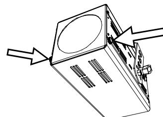
3. Ослабьте два винта, фиксирующих кронштейн ламподержателя.
