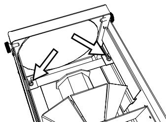
4. Выньте кронштейн ламподержателя из направляющих пазов.
